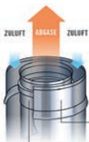
**DAS KONZENTRISCHE ROHRSYSTEM** (mit einem Innen- und einem Aussenrohr) ermöglicht die Zufuhr der Verbrennungsluft und die Ableitung der Abgase mit demselben System.
