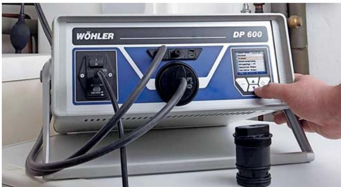
Prüfgerät für die Druckprüfung von Abgasanlagen
