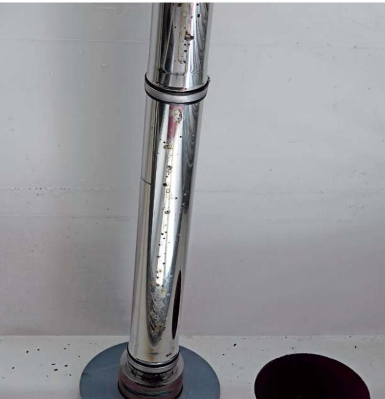
Lochfrass: wiederholte Kondensation in der einfachwandigen Partie im Verbindungsrohr
