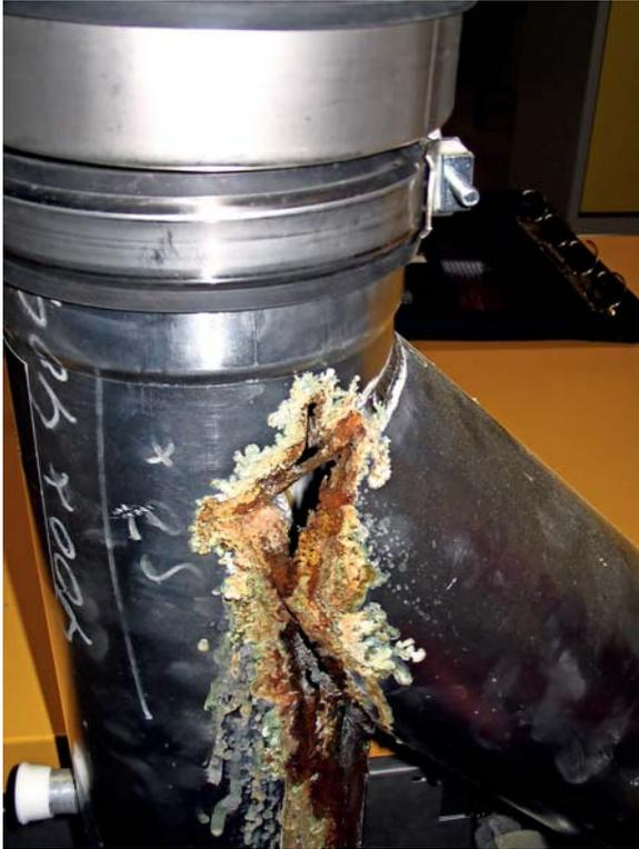
Schweisfehler entstehen durch die ungenügende Qualität der Zusatzwerkstoffe, schlechte Vorbereitung, fehlerhafte Schweißnaht und fehlende Beizung.
