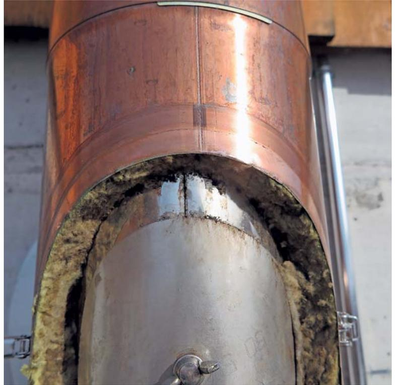
Schweißnaht-Korrosion, fehlender Zusatzwerkstoff und stattfindende Korrosion auf der Innenseite des Rohres
