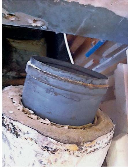
Bild 7: Zunder auf Edelstahlrohr
